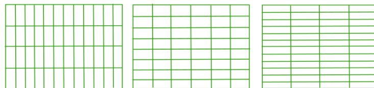
Figure 2.4 – Schéma simplifié représentant des patterns de masquage temps-fréquence suivant l'échelle ERB, à 43 bandes (à gauche), à 86 bandes (au milieu) et à 128 bandes (à droite).
